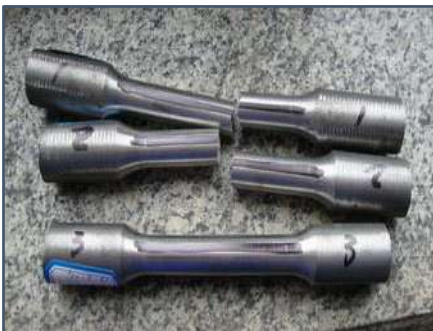
Tensile Test Bar (OSP)
